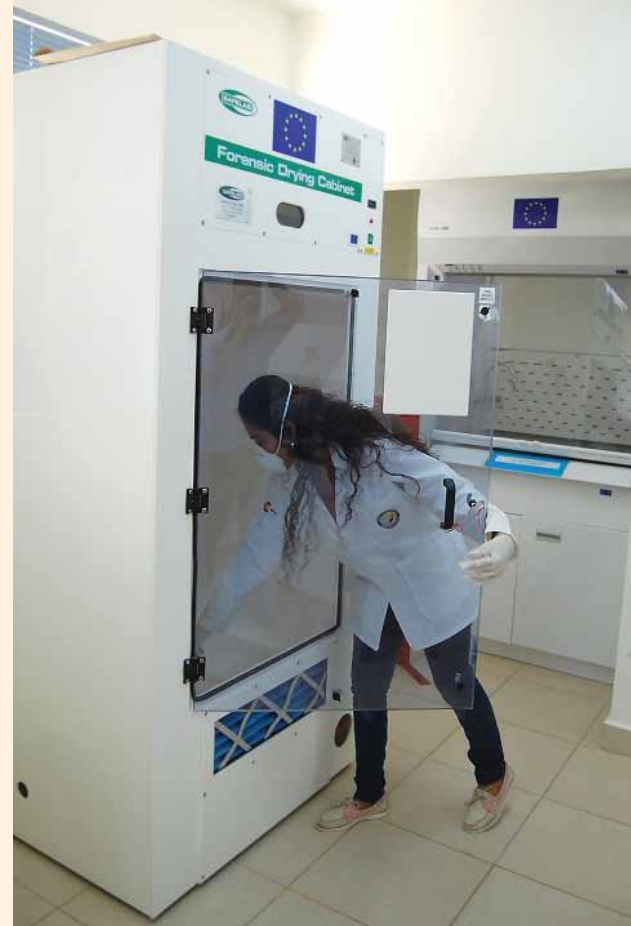
▶ DESHUMIFICADOR. Es un gabinete forense que se utiliza para extraer la humedad de prendas de vestir con manchas hemáticas y elimina malos olores a las evidencias.
