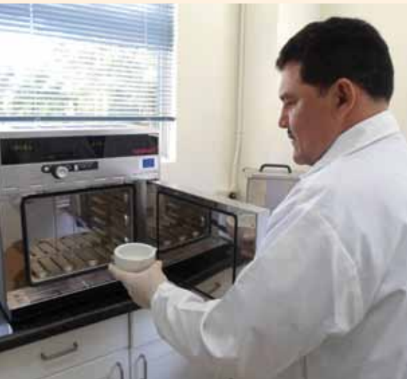
HORNO DE PRECISIÓN. Se utiliza para secar y esterilizar cristalería y para realizar el análisis de alcoholemia en la que se da una oxidación a causa de la reacción entre el alcohol y la solución sulfocrómica.
