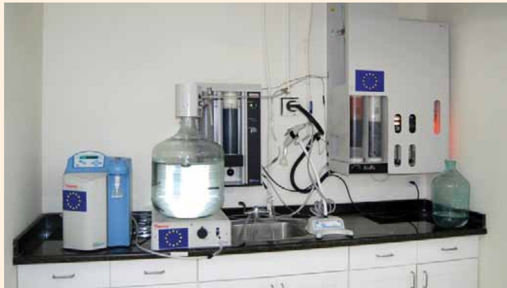
DESTILADOR DESIONIZADOR Y DESMINERALIZADOR DE AGUA. Equipo compuesto por tres accesorios que producen diferentes calidades de agua, como agua destilada, agua desionizada y agua ultrapura, utilizadas en los diferentes análisis instrumentales como Espectrofotometría de Absorción Atómica, Cromatografía de Gas Masa Masa, Cromatografía Líquida.
