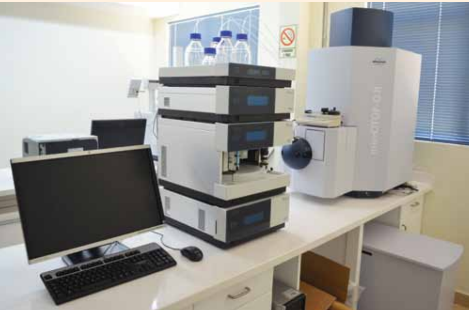
▲ CROMATÓGRAFO LÍQUIDO DE ALTA RESOLUCIÓN con detector de masa-masa, con la técnica Cuadrupolo Tiempo de Vuelo, utilizada para la identificación de droga y fármacos.
